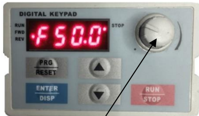
TYP A Potenciometer POT na externom panely
