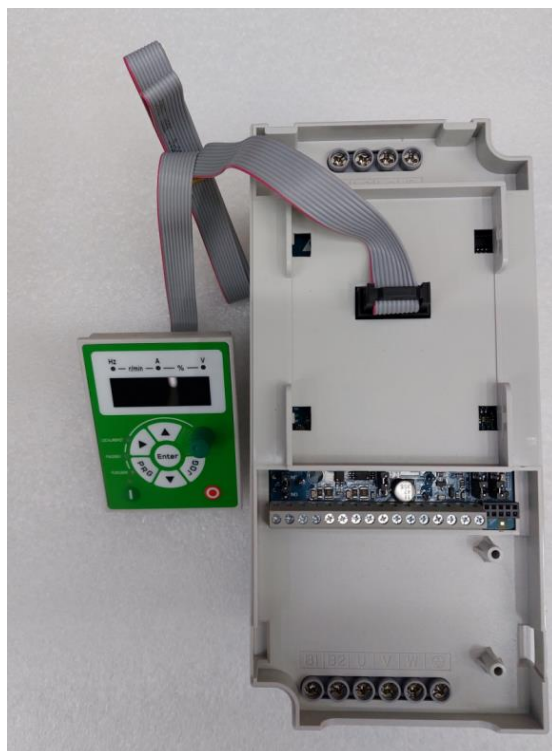
Nainštalovaný predĺžovací kábel EXTCAB-A12
